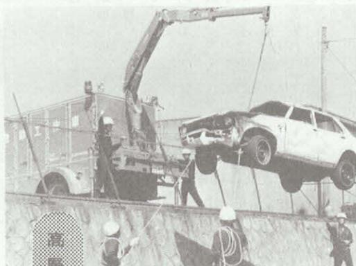
道路下に転落した事故車両のつり上げ作業をする救助工作車
